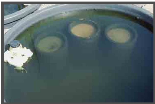
Bild 2: Totalausfall der Wasserpflanzen in einem Becken mit Herbizidbehandlung.
